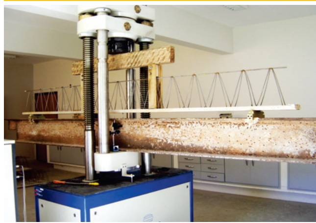
Figura 10 – Ensaio de flexão
