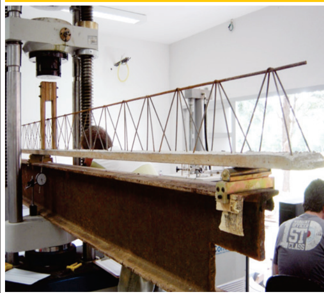
Figura 12 – Ensaio de cisalhamento
