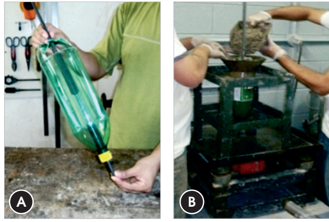
Figura 4 - (a) Molde de garrafa PET (b) Concretagem do molde de garrafa PET sobre o suporte metálico
