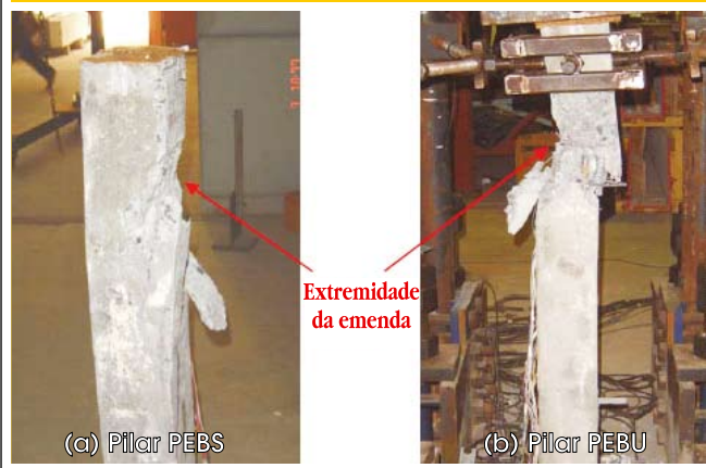
Figura 7 - Região da ruptura dos pilares
