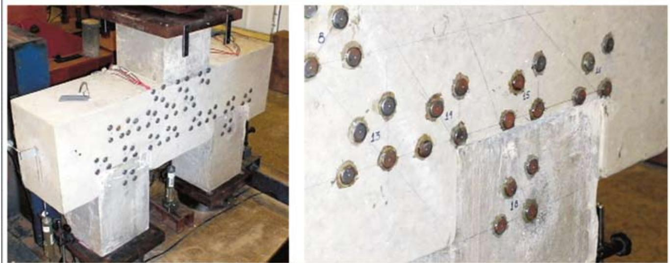
Figura 17 - a) posição da primeira fissura; b) plano de ruptura ao longo da altura do bloco
