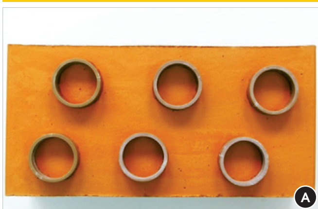
Figura 4 - Produção dos corpos de prova para a realização do ensaio de resistência de aderência à tração (a) a fim de eliminar a etapa de corte os corpos de prova foram moldados com auxílio de molde cilíndrico de PVC com diâmetro de 50 mm x 20 mm de espessura; (b) corpos de prova após moldagem da argamassa e retirada do molde cilíndrico; (c) vista lateral do corpo de prova após a colagem da pastilha; e (d) dinamômetro utilizado para execução do ensaio - Dynatest DTE - 5000. Fotos: Mário Takeashi
