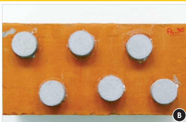
Figura 4 - Produção dos corpos de prova para a realização do ensaio de resistência de aderência à tração (a) a fim de eliminar a etapa de corte os corpos de prova foram moldados com auxílio de molde cilíndrico de PVC com diâmetro de 50 mm x 20 mm de espessura; (b) corpos de prova após moldagem da argamassa e retirada do molde cilíndrico; (c) vista lateral do corpo de prova após a colagem da pastilha; e (d) dinamômetro utilizado para execução do ensaio - Dynatest DTE - 5000. Fotos: Mário Takeashi
