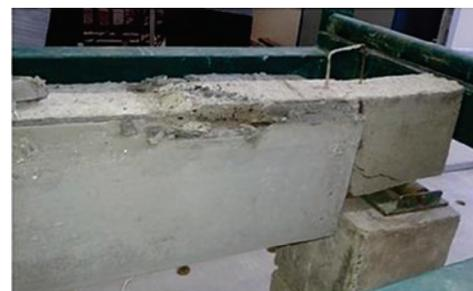
f) Aspecto final da viga após ruptura apoio esquerdo/face esquerda
