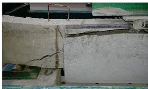
e) Ruptura na viga por cisalhamento apoio esquerdo/face direita
