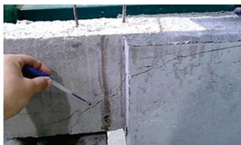
b) Fissura cisalhamento apoio direito/face esquerda
