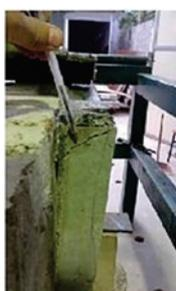
d) Fissura no graute apoio direito/face esquerda
