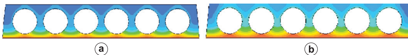
Figura 14 Campo de temperatura na seção transversal da laje alveolar - terceira estratégia: a) 60 minutos; b) 120 minutos
