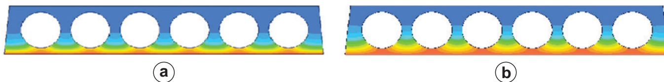
Figura 12 Campo de temperatura na seção transversal da laje alveolar - primeira estratégia: a) 60 minutos; b) 120 minutos
