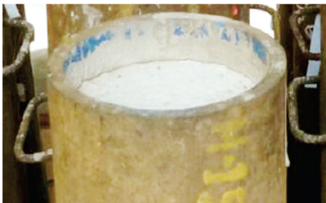
Figura 4 Detalhe do vazio de 50 mm deixado durante a concretagem
