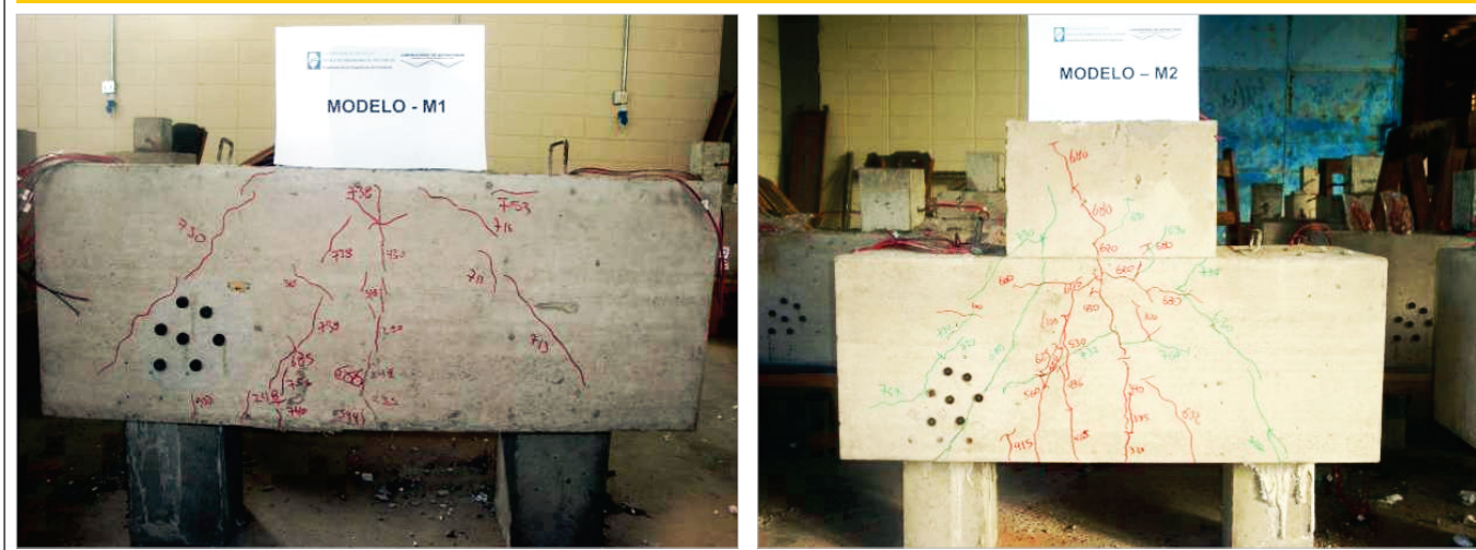
Figura 11 – Panorama de fissuração dos Modelos M1 e M2 após o ensaio
