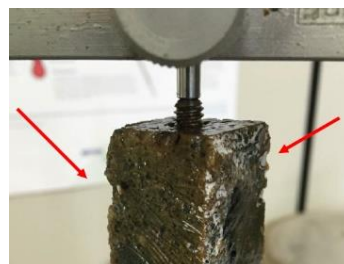
Figura 4: Corpo-de-prova do CSS_80_F exposto à solução de sulfato de sódio por 84 dias.
