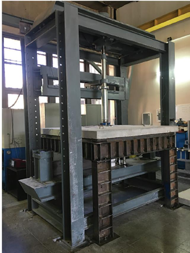
Figura 20: Montagem do ensaio realizado por TORABIAN *et al.* [4].
