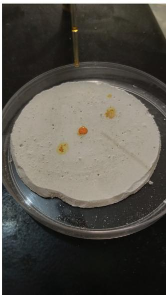
**Figura 1:** Teste de Impermeabilização (autoria própria).
