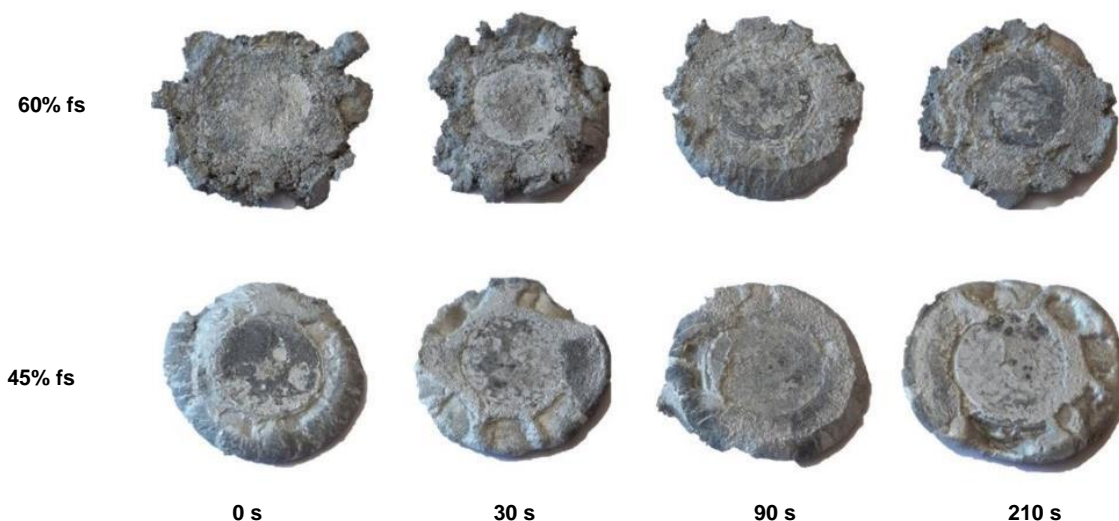
Figura 3: Amostras tixoconformadas pelo ensaio de compressão a quente entre placas paralelas da liga AA7004 para as frações sólidas de 60% e 45% e tempos de tratamento térmico de reaquecimento de 0, 30, 90 e 210 s.
