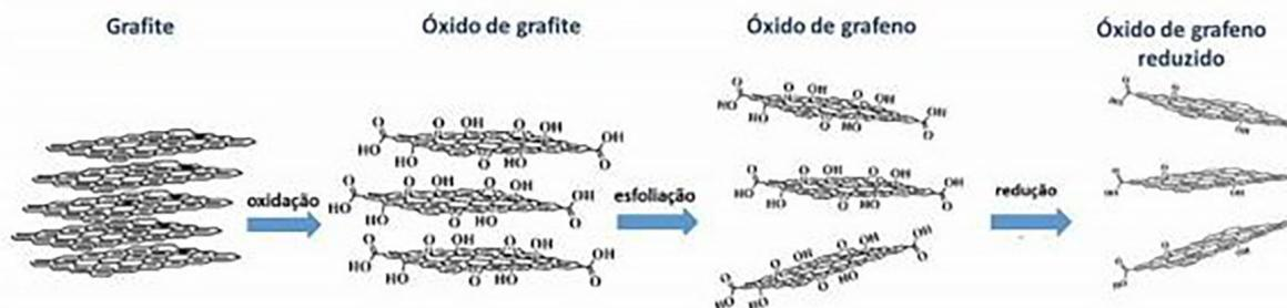
Figura 1: Método de Hummers para a obtenção de OG [4].
