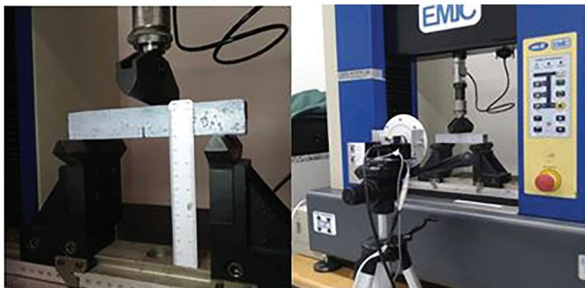
**Figura 11:** Ensaio de flexão em três pontos, à esquerda. Realização de imagens para aplicação do método DIC, à direita.
