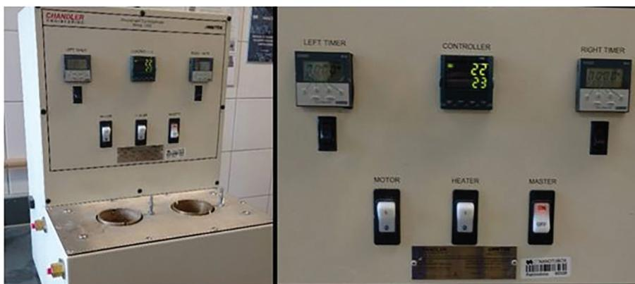
**Figura 10:** Consistômetro atmosférico utilizado na homogeneização das pastas: à esquerda o perfil do equipamento e à direita o painel de controle.
