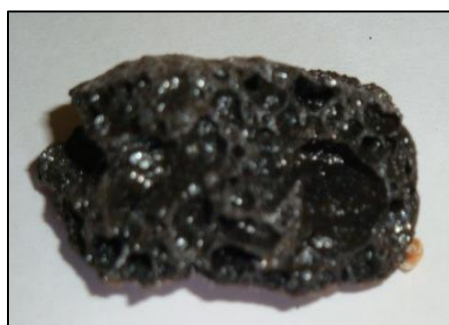
Figura 5: Macrografia em corte longitudinal no agregado sintético
