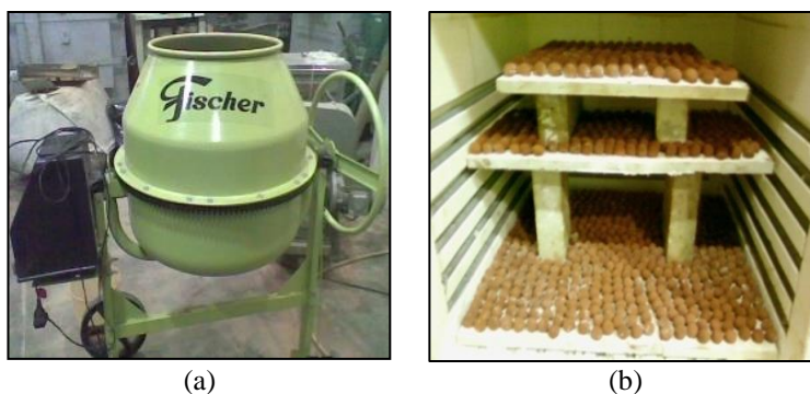
Figura 2: Produção de agregado com auxílio de tambor rotativo (a) e queima em forno elétrico de câmara (b).
