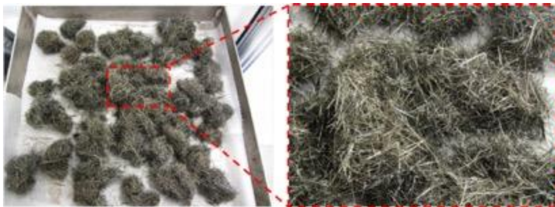
Figura 6: “Ouriços” formados pelas fibras após a agitação mecânica na funcionalização
