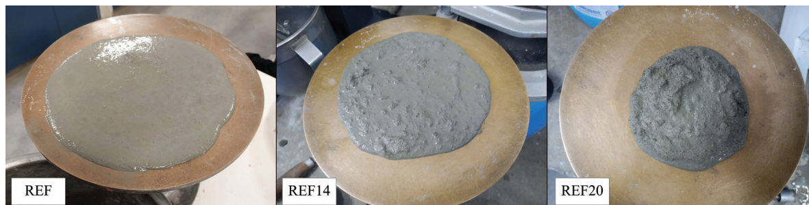
Figura 2: Consistência das misturas (referência à esquerda, com adição de 1,4% de fibra de N-95 ao centro e 2,0% à direita).
