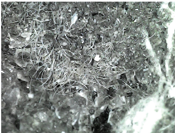
Figura 9: Amostra com 2,0% de fibra N-95 (REF 20).
