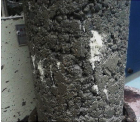
Figura 3: Presença de cristais na superfície externa do corpo de prova com adição de lodo de ETA
