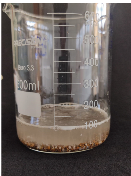
Figura 5: Liberação imediata de CO_2 na interação entre fração -10# +20# e ácido fosfórico 10% (v/v).
