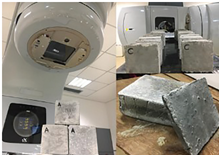
Figura 5: CP's prismáticos utilizados durante o processo de irradiação.
