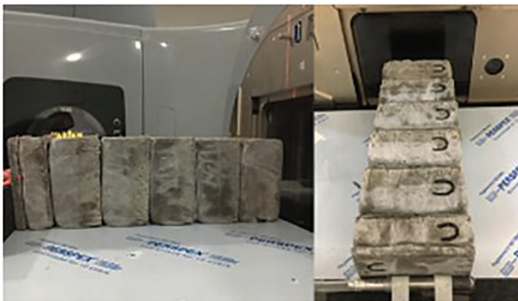
Figura 9: Espessura máxima atingida (34,0 cm) com sete CP's prismáticos.
