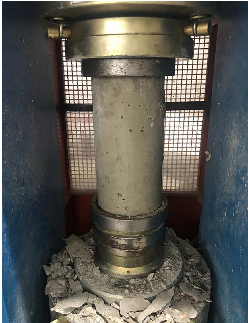
Figura 15: Ensaio à compressão axial na prensa hidráulica.
