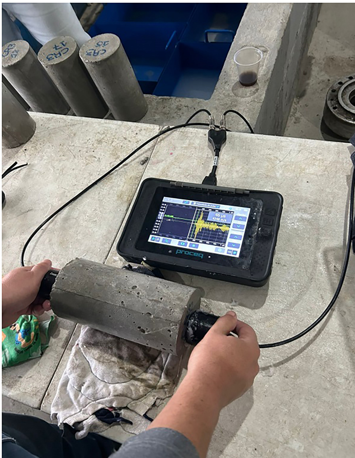
Figura 13: Ensaio de velocidade de onda ultrassônica.
