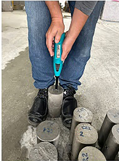
Figura 14: Ensaio de esclerometria.
