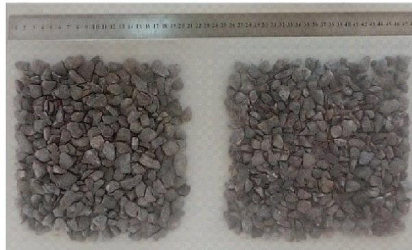
(b) Amostras de ARCO antes (esquerda) e após (direita) os ensaios de resistência de conexão.
