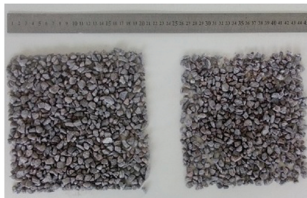
(a) Amostras de AN antes (esquerda) e após (direita) os ensaios de resistência de conexão.
