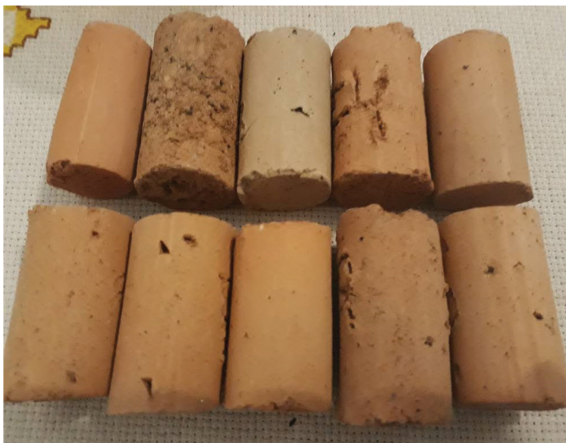
Figura 5: Análise visual das peças que comprovam o não aparecimento de eflorescência.
