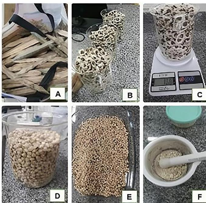
Figura 2: Processo de preparação do pó de semente de Moringa. (A) Vagens como recebidas; (B) sementes; (C) pesagem das sementes; (D) lavagem dos grãos; (E) grãos secos em forno; (F) grãos macerados.
