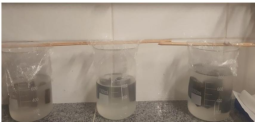
**Figura 7:** Amostras sob imersão em solução tratada com moringa no primeiro dia de ensaio (27/04/2022).
