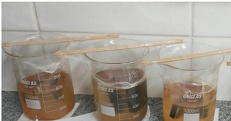
Figura 8: Amostras sob imersão de solução tratada com moringa após 30 dias.
