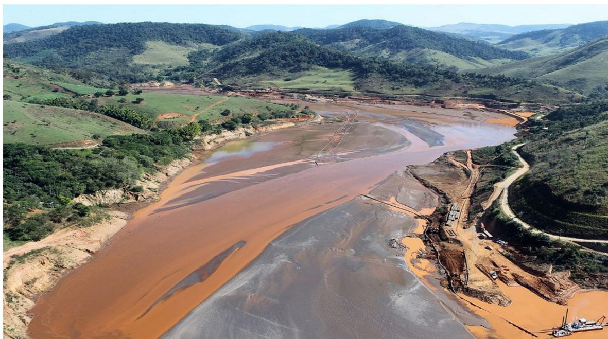
**Figura 6:** Usina Risoleta Neves inoperante devido ao acúmulo de rejeitos próximo à crista da barragem [29].
