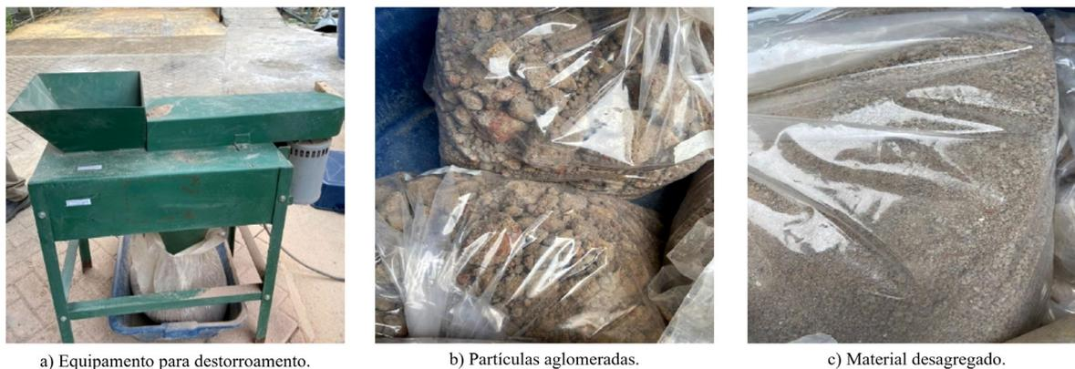
**Figura 7:** Destorroamento de materiais [31].
