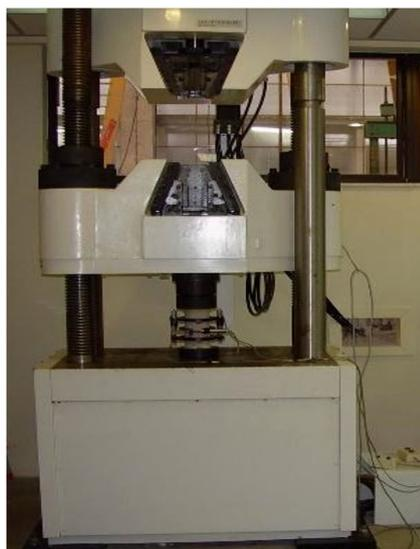
a) Prensa utilizada no ensaio de RCS.
