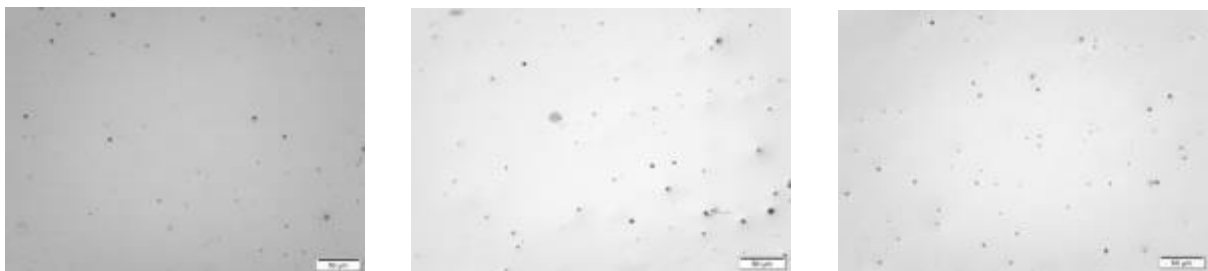
Figura 1: Microfotografias das amostras sem ataque químico. Em (a) revenido a 310 °C, (b) 425 °C e (c) 610 °C por 1 h.
