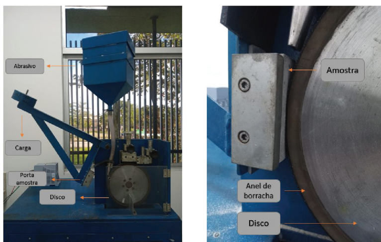
Figura 4: Abrasômetro do tipo roda de borracha.
