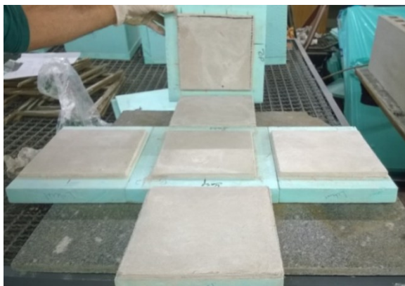
Figura 3: Célula de teste, em escala reduzida, revestida com argamassa com incorporação de microcápsulas de PCM.
