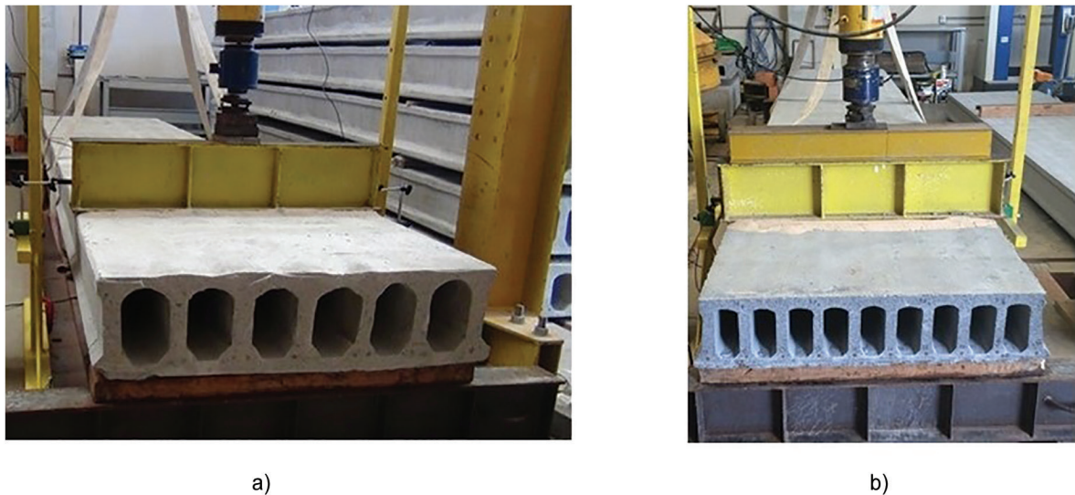
Figura 9: Vista dos Ensaios de Cisalhamento: (a) laje de 300 mm de altura [14], (b) laje de 200 mm de altura [15].
