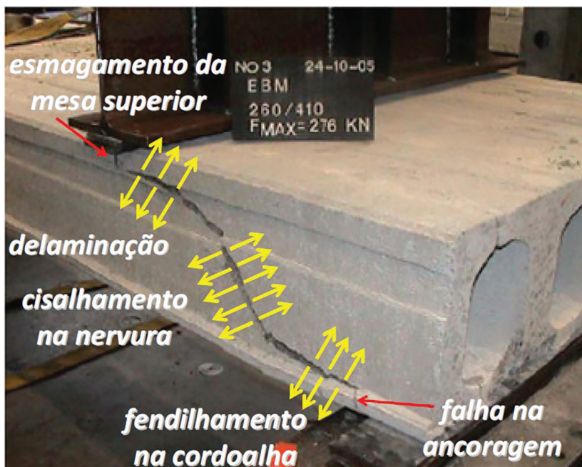
Figura 4: Mecanismos de comportamento para lajes de maior altura. Fonte: Bertagnoli & Mancini (2009) apud [1].
