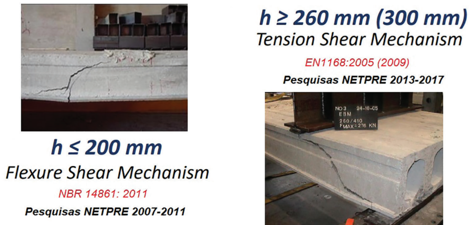
Figura 6: Modos de ruptura para lajes baixas versus lajes altas [12].
