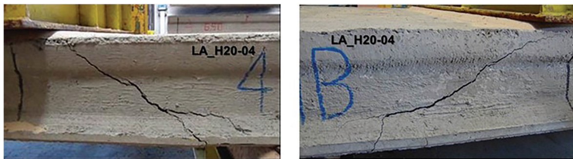
Figura 17: Ruptura por cisalhamento com flexão e falha de ancoragem – LA_H20-04 [15].
