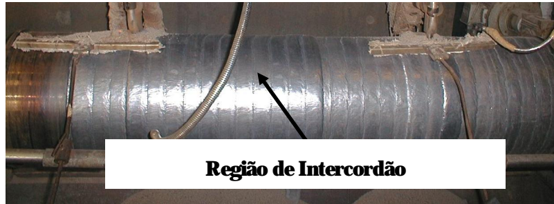
Figura 1: Recuperação do rolo de lingotamento contínuo pelo processo de soldagem por arco submerso, utilizando dois cabeçotes oscilatórios (cortesia de Ronaldo Paranhos). Em destaque a região de rea aquecimento.
