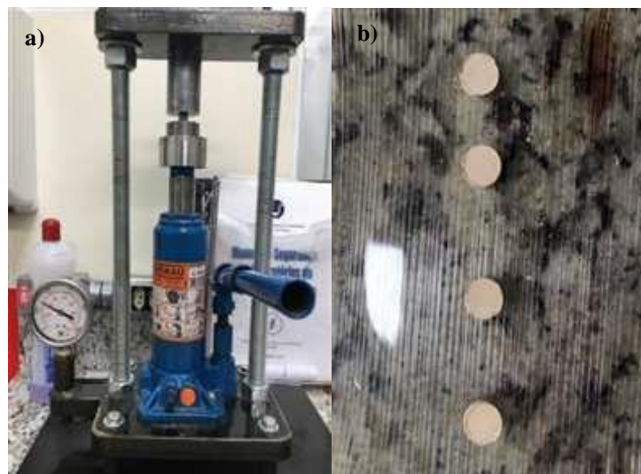
Figura 3: Equipamento e amostras: a) Prensa hidráulica (4 ton.); b) Materiais prensados em formato de pastilhas.
