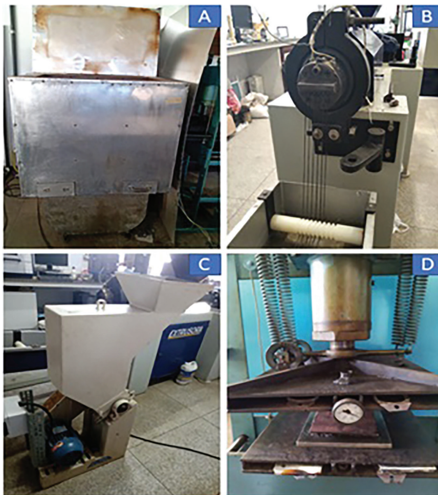
Figura 4: Processamento para produção de do composto: tamboreamento (A); extrusão (B); peletização (C); termo prensagem (D).
