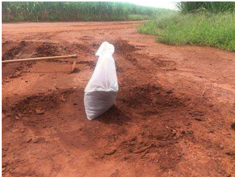
Figura 1: Forma de coleta de amostra de solo.
