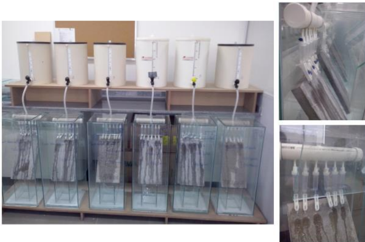
Figura 5: Ensaio em execução do teste de lixiviação por irrigação
