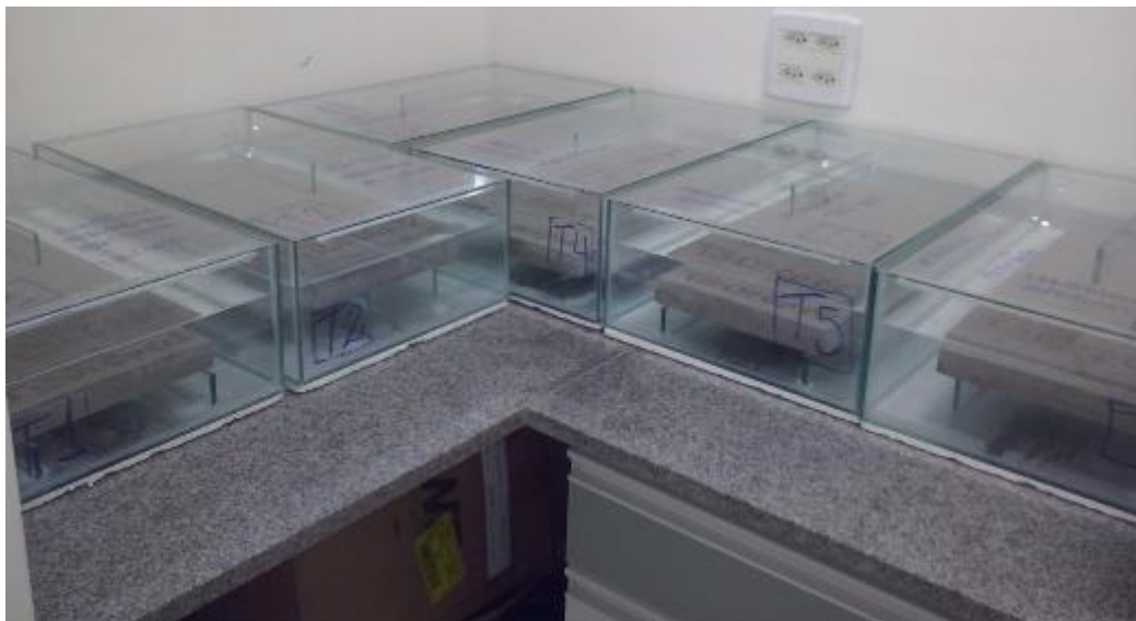
Figura 4: Ensaio em execução do teste de lixiviação por imersão
