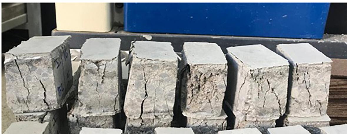
**Figura 20:** Ruptura das amostras dos blocos BR 16. Fonte: Autor (2023).
