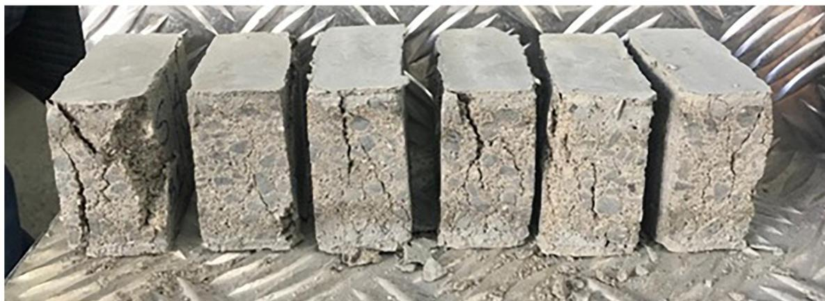
**Figura 19:** Ruptura das amostras dos blocos BR 4. Fonte: Autor (2023).
