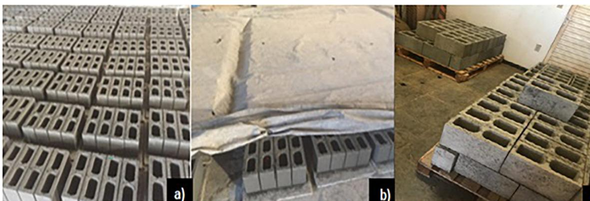
**Figura 6:** Blocos de concreto: a) distribuídos no barracão, b) cobertos com lona, c) armazenados em sala isolada. Fonte: Autor (2022).
