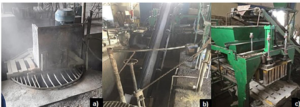
**Figura 5:** Equipamentos empregados na fabricação dos blocos: a) misturador, b) esteira, c) máquina vibroprensa. Fonte: Autor (2022).
