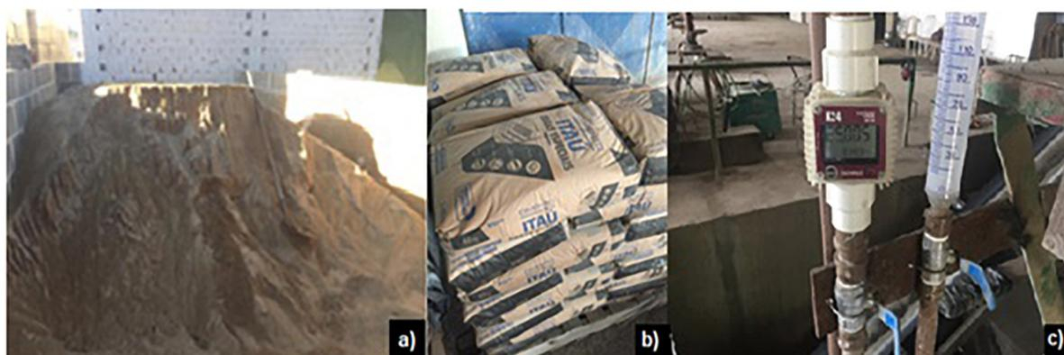
**Figura 4:** Matérias – primas: a) baia de agregados naturais, b) cimento ensacado, c) dispositivos de controle de água e aditivo. Fonte: Autor (2022).
