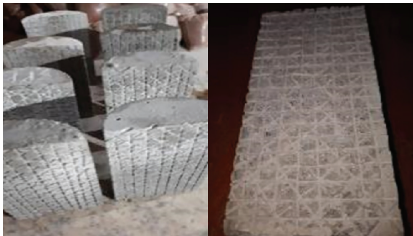
Figura 11: Corpos de prova submetidos a tratamento superficial.
