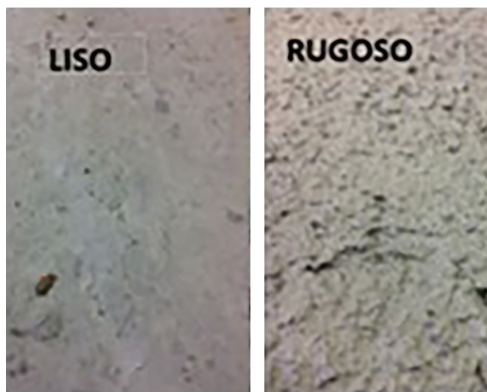
Figura 5: Ilustrações das rugosidades produzidas nos substratos de concreto.
