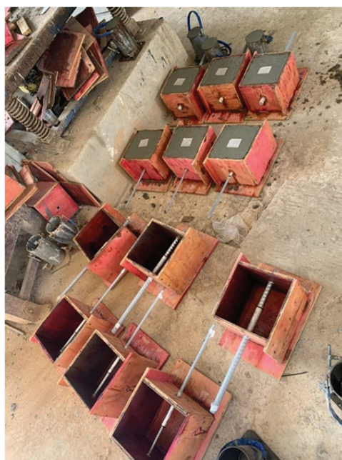
Figura 3: Corpos de prova durante a concretagem (Fonte: Autor).
