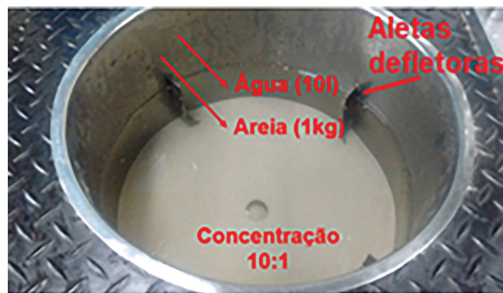
Figura 4: a) Areia sílica usada nos testes. b) Vista interna do tanque com mistura abrasiva (água + areia).
