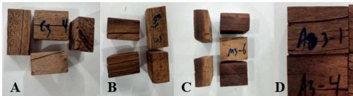
**Figura 6:** Trincas em alguns corpos-de-prova termorretificados a 170°C em Cedro (A), Quaruba (B), Muiracatiara (C) e Angelim (D).
