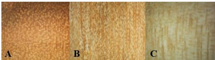
**Figura 9:** Observações de *Astronium ulei* Mattick, nos planos transversal (A), tangencial (B), radial (C).
