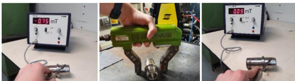
**Figura 9.** Sequência de desmagnetização do corpo de prova 2.
