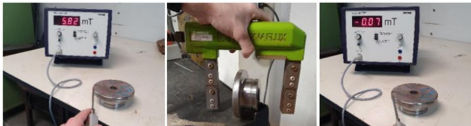
**Figura 8.** Sequência de desmagnetização do corpo de prova 1.
