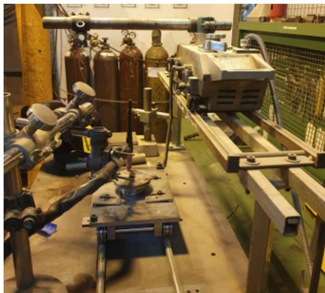
Figura 7. Montagem experimental para soldagem TIG.
