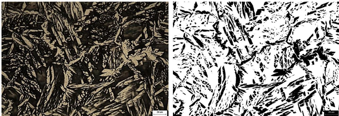
Figura 7. Imagens exemplificando o processo de quantificação por análise de imagens.
