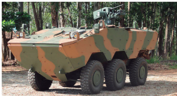
Figura 13 Protótipo REMAX 2 integrado à VBTP-MR Guarani
