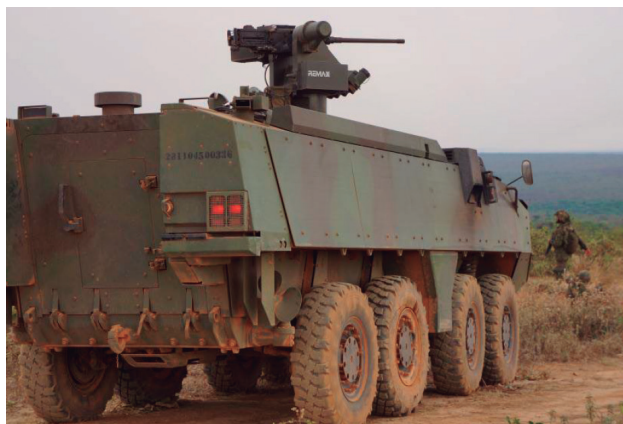
Figura 14 REMAX 3 instalado na Viatura Piranha do Corpo de Fuzileiros Navais (CFN)
