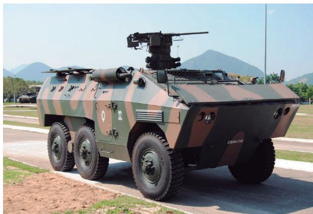
Figura 12 REMAX 1 integrado a VBTP-MR Urutu
