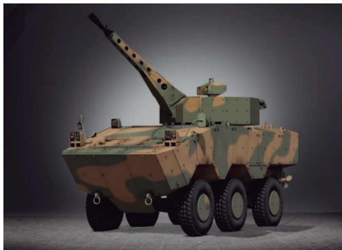
Figura 18 TORC30 integrada à VBTP-MR Guarani
