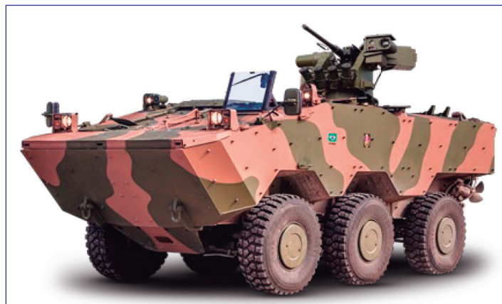
Figura 15 REMAX integrado na VBTP-MR 6x6 Guarani
