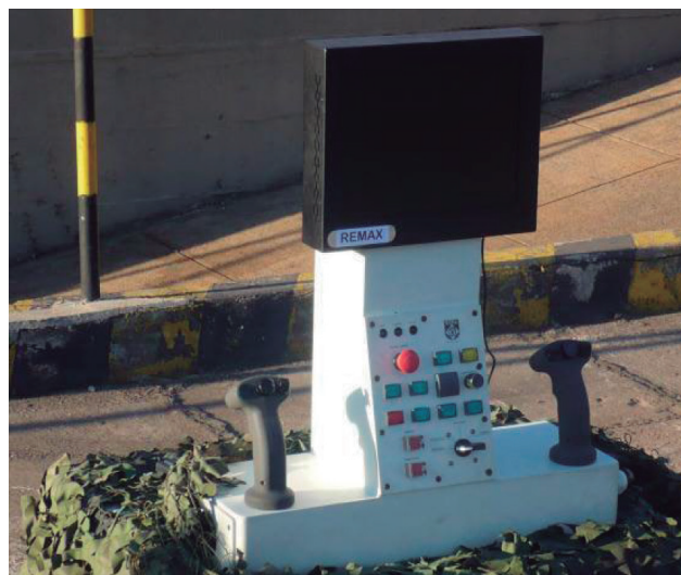
Figura 11 Painel de controle do REMAX 1
